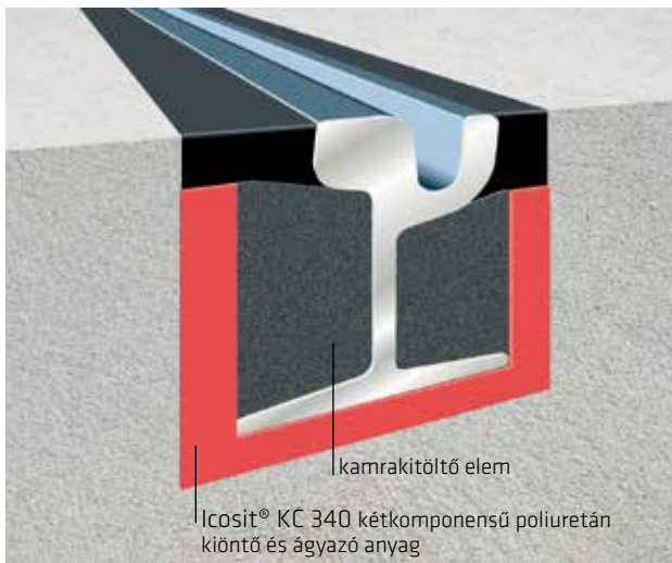
Vályús síncsatornás felépítmény kamrakító elemmel
