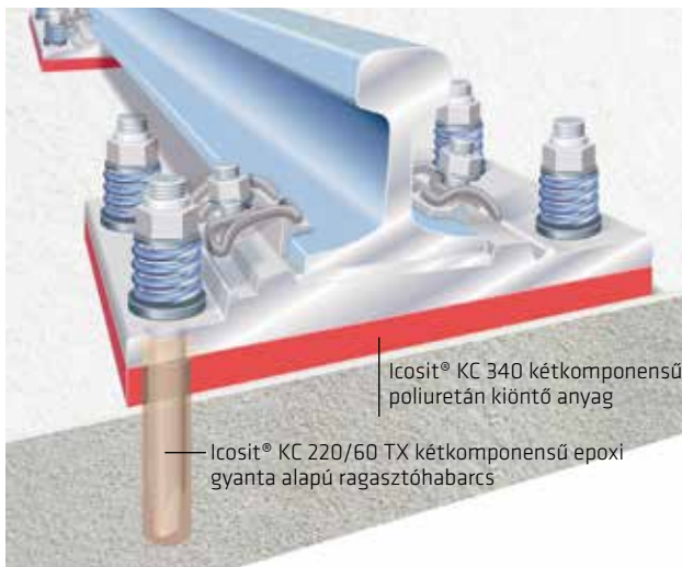
A diszkrét rögzítés esetén a rögzítést ragasztott töcsavarok, a rugalmas viselkedést pedig az Icosit® KC kiöntőanyag biztosítják.
