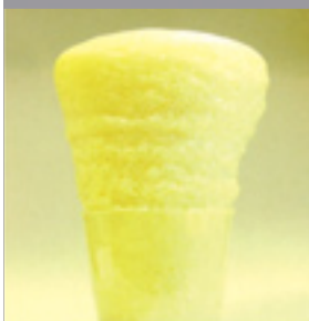
A Sika® Injection-101 szabad duzzadási képessége több mint 40-szeres.
