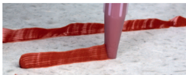
Alsó kép: Tömítőanyag használata ragasztóanyagként a profilhoz.
