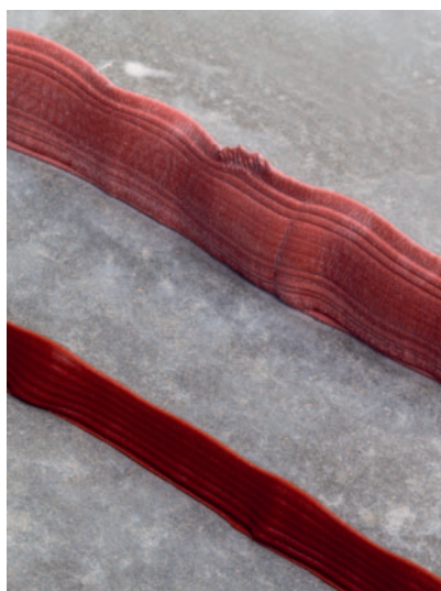
A termék normál és duzzadt állapotában, vízzel való érintkezést követően.
