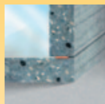
A SikaSwell® - P duzzadásának következtében kialakuló nyomás biztosítja a hézag vízzáróságát
