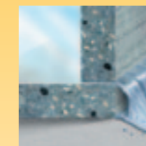
SikaSwell® S-2 nélkül a víz keresztülfolyik a hézagokon
