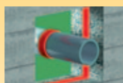
A SikaSwell® - P duzzadásának következtében kialakuló nyomás biztosítja a hézag vízzáróságát
