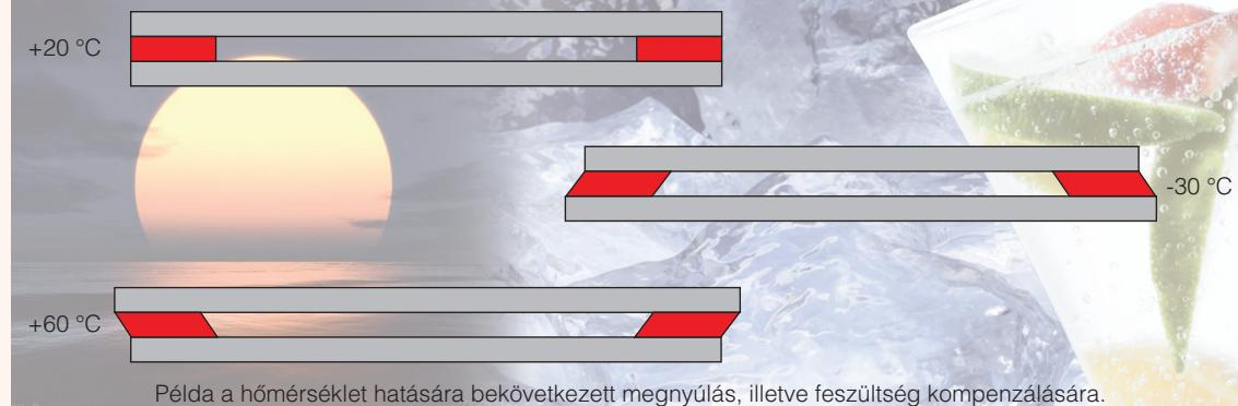
Példa a hőmérséklet hatására bekövetkezett megnyúlás, illetve feszültség kompenzálsára.
