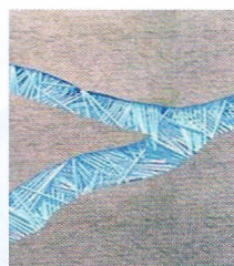
3-4. kép A Sika WT-200 sűrű kristálmátrixot képez a beton kapilláris rendszerében
