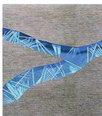
3-4. kép A Sika WT-200 sűrű kristálmátrixot képez a beton kapilláris rendszerében
