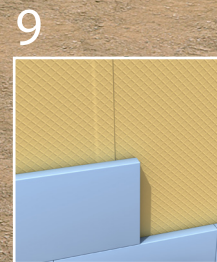
Szigetelést védő réteg / geotextília és hőszigetelő táblák
