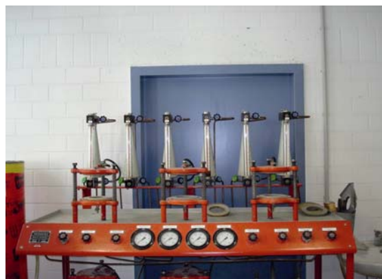
3. ábra: Vízzáróság vizsgáló berendezés A beton nyomás alatti vízfelszívását a maximális vízbehatolással mm-ben lehet mérni egy meghatározott időtartam és adott nyomás esetén. (24 óra időtartam 5 bar nyomáson az MSZ EN 12390-8 szabvány szerint)
