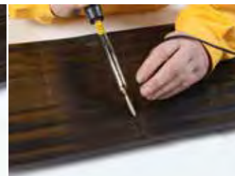
Megerősítés hegesztőzsinórral hegesztőcsúcs alkalmazásával
