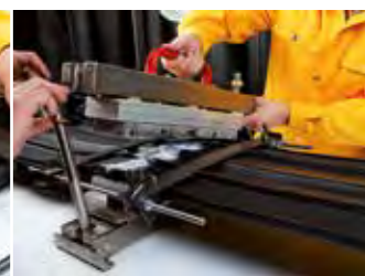
Fugaszalag beszórása és behelyezése a vulkanizáló berendezésbe
