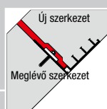
Szorítólemez vízzáró szalag meglévő és új épület közti hézag vízzáróságának biztosítására
