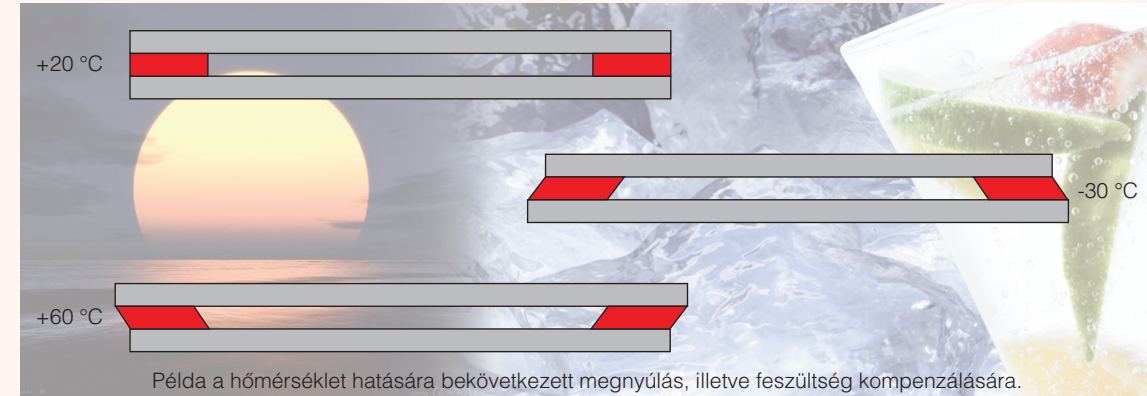
Példa a hőmérséklet hatására bekövetkező megnyúlás, illetve feszültség kompenzálására.
